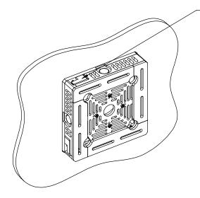
**5.** ATTACH THE DEVICE TO THE ADAPTER PLATE
