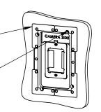
5. ATTACH TOUCH SCREEN TO INSERT THE SCREEN, HOLD THE SCREEN AT A SLIGHT ANGLE AND FIRST ENGAGE THE WALL PLATE HOOK, THEN RELEASE THE SCREEN TO ATTACH MAGNETICALLY
